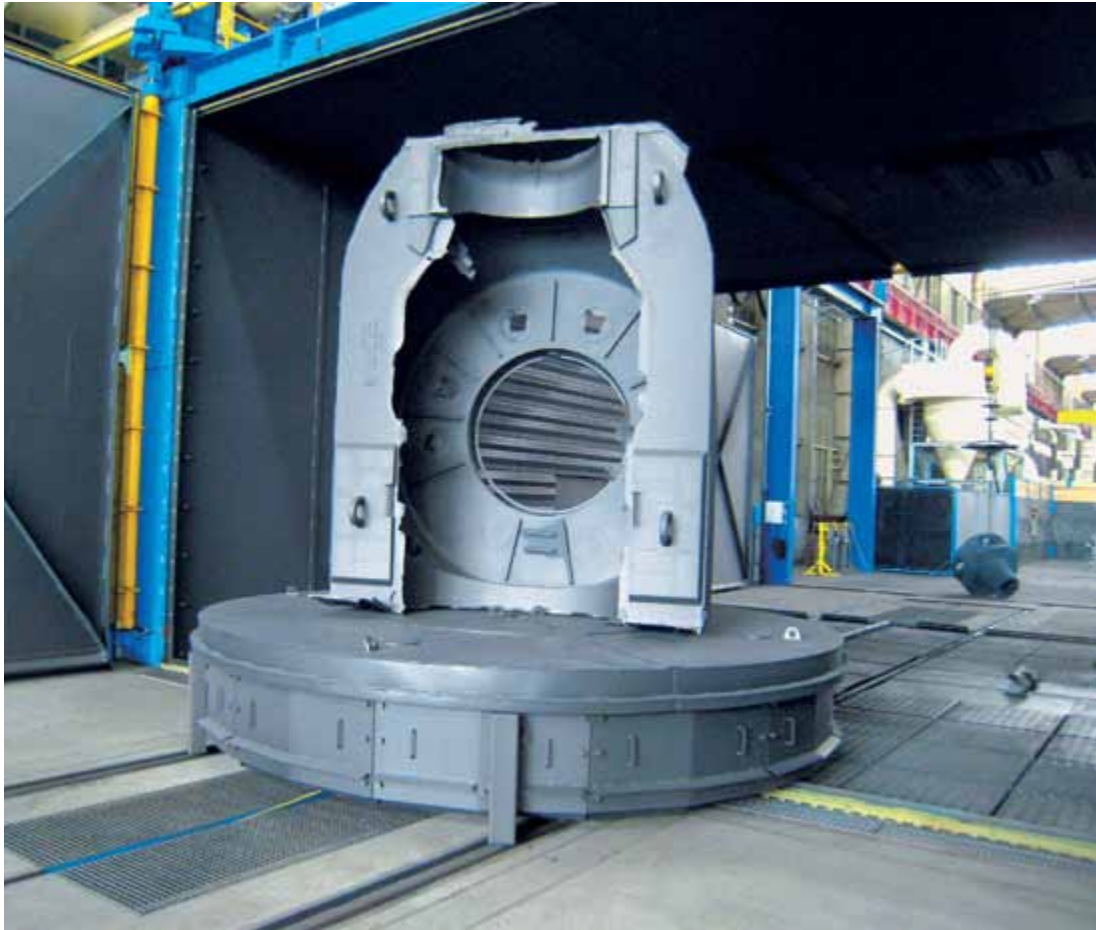
Strahlanlagen für Gusswerkstücke mit Transportwagen über ein Schienensystem ...
