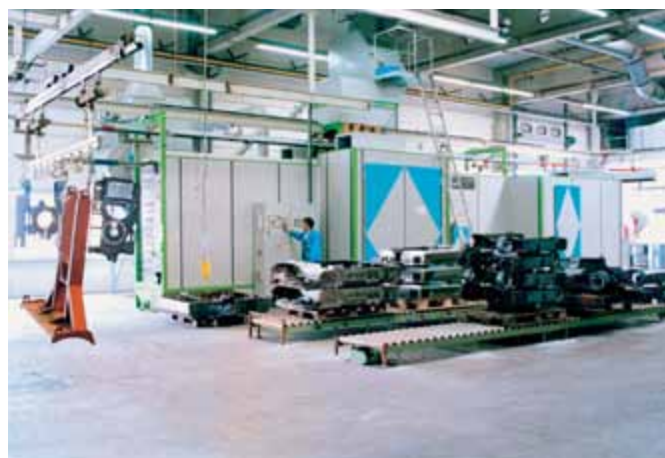
Hängebahn-Strahlanlagen für verschiedenste Werkstückabmessungen und -ausführungen
