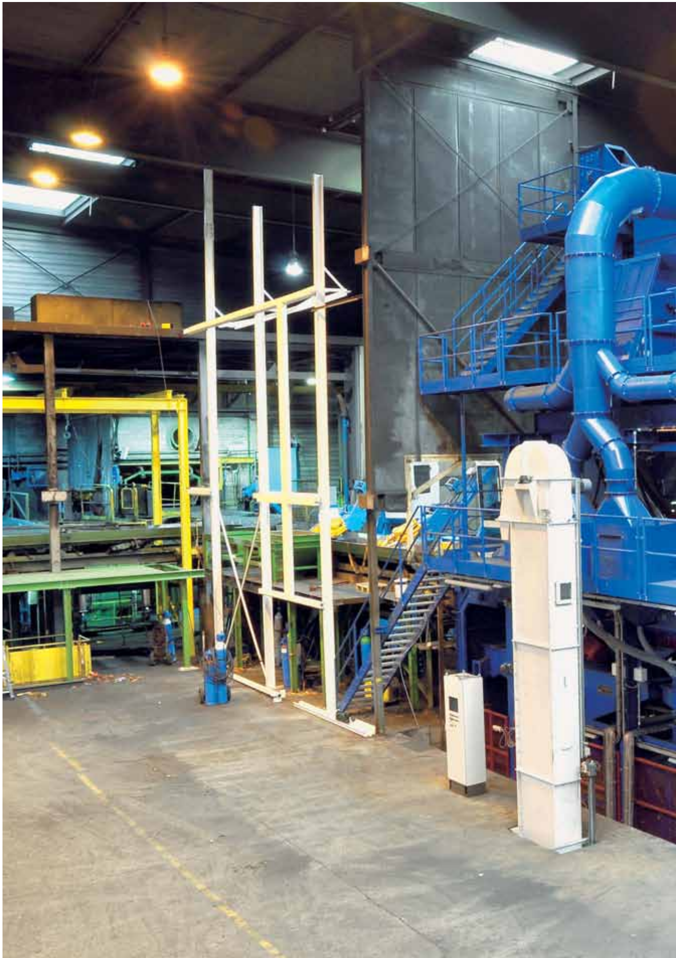
Drahtgurt-Strahlanlage 20-D-1500 mit 16 Turbostrahlern je 22 kW Wire belt shotblasting machine 20-D-1500 with 16 shotblasting wheels each 22 kW
